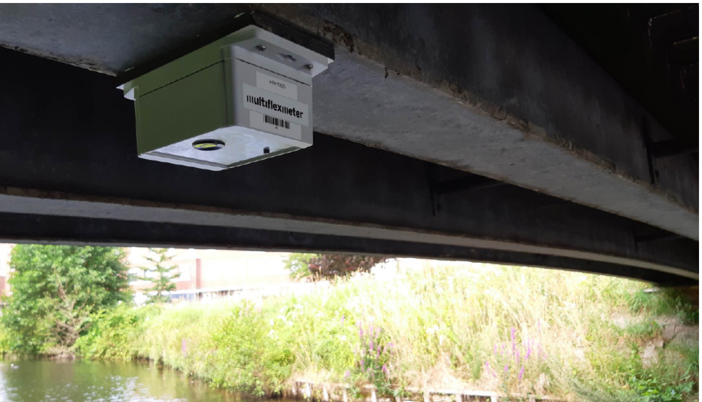
Deze waterpeilsensor meet de waterstand en geeft het door via Lora. Foto: Marinus van Dijk
