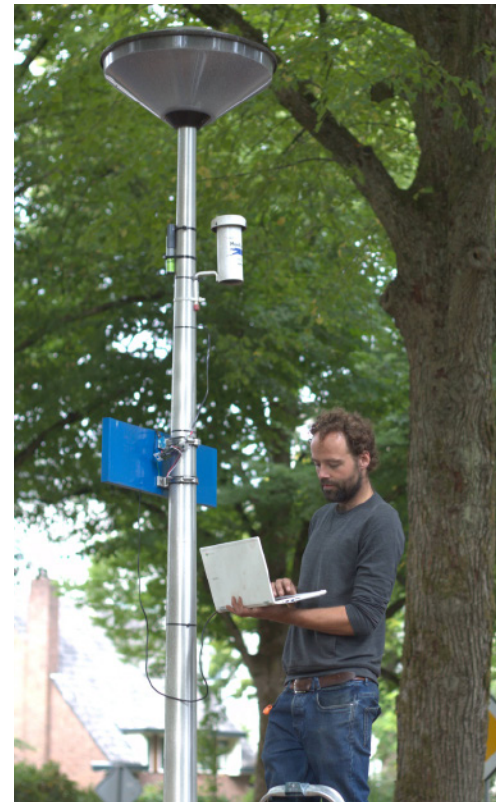
Via een lora-zender worden in Amersfoort de gegevens over bodemvocht doorgestuurd.
